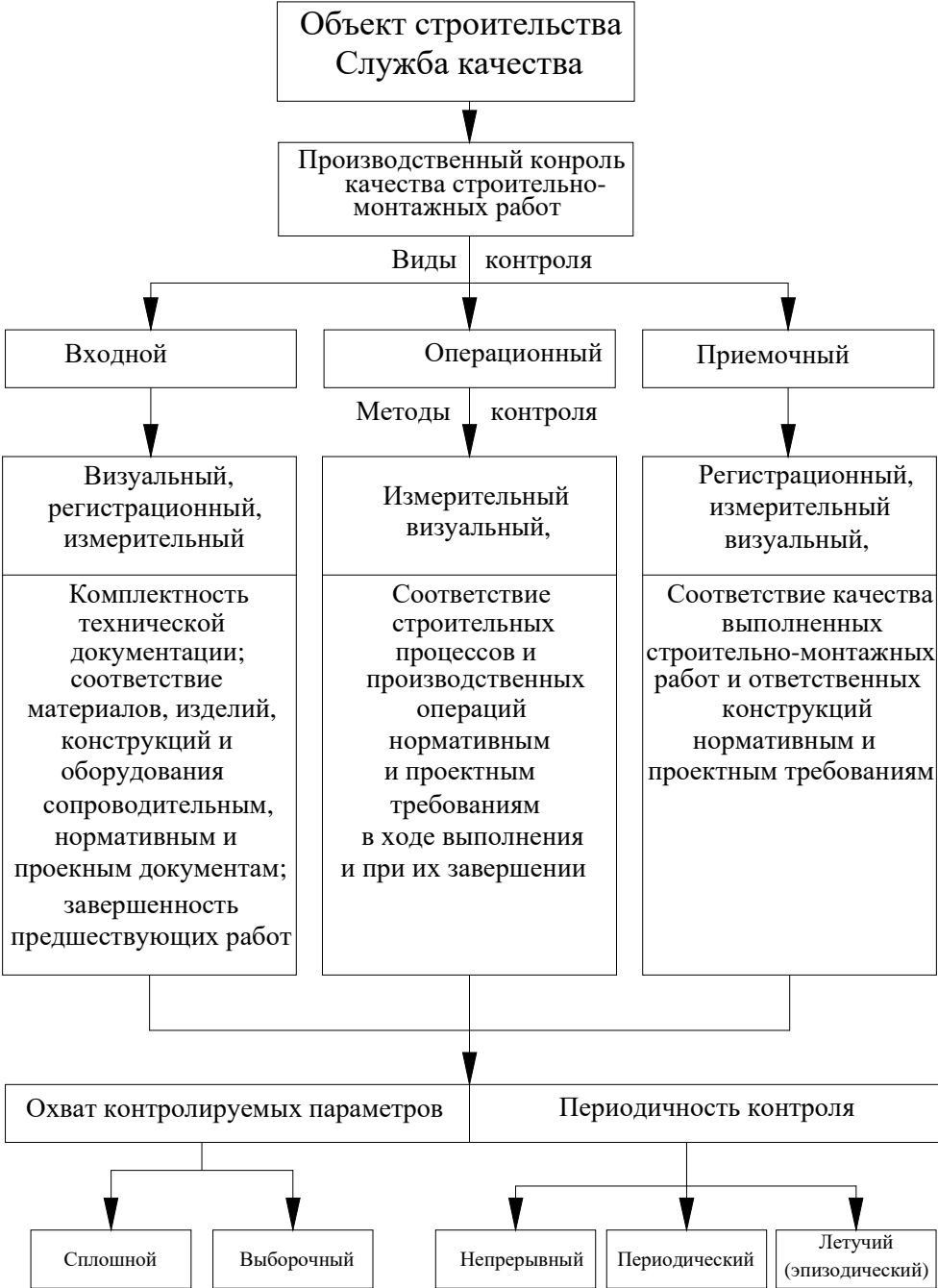
Рисунок 13.1 - Схема производственного контроля качества строительно-монтажных работ
